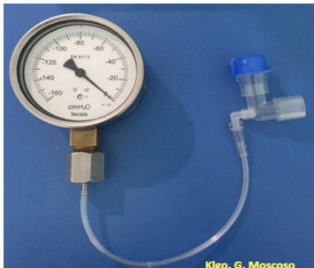
Figura 1. Vacuómetro aneroides, con circuito para medir PiMant
